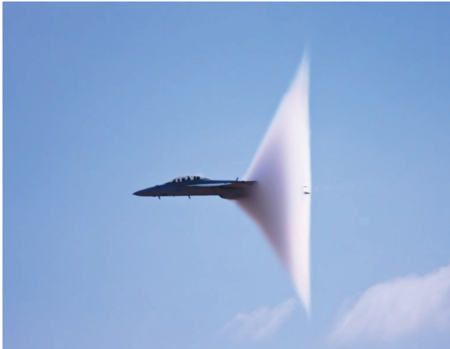
Fig.2 – Cône de brouillard à l'arrière d'un avion supersonique.
